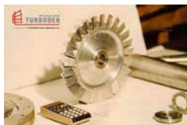
FIGURA 12 - La prima turbina ORC progettata al Politecnico di Milano
